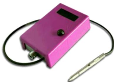
Oltre alla funzione di base del modello Standard, è dotato di SIM card ed in grado di inviare un SMS a dispositivi mobili o ad una piattaforma web, in caso di apertura o manomissione del cavo e/o delle porte del mezzo a cui può essere applicato.
