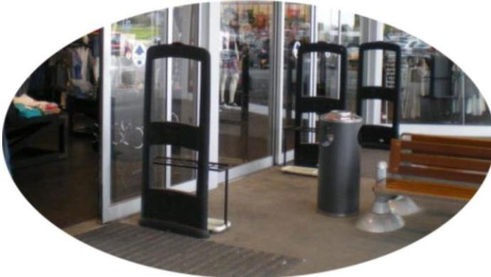
**Il Reader è un ricetrasmittitore, collegato con il sistema di gestione, in grado di leggere le informazioni contenute nelle etichette RFID.**
