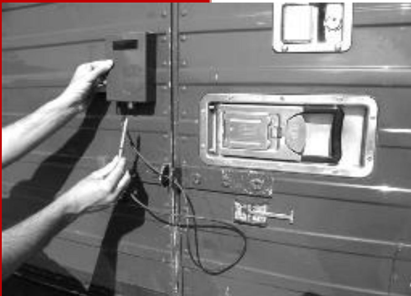
**eLOCK GOLD** è un'avanzata chiusura di sicurezza riutilizzabile, la quale controlla la posizione e lo stato del camion o del container, mediante l'impiego di tecnologia GPS e comunicazione GSM/GPRS, usando sia dispositivi fissi che mobili (smartphones e tablet).
