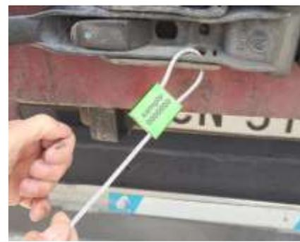
Inserire il cavetto nel foro della testa del sigillo e tirare quanto più possibile.
