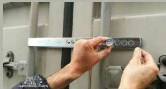
Onde evitare aperture anche minime delle porte del container, è opportuno bloccare le due barre centrali quanto più strette possibile. Ciò è reso possibile dalla sequenza dei fori del FORKSEAL.
