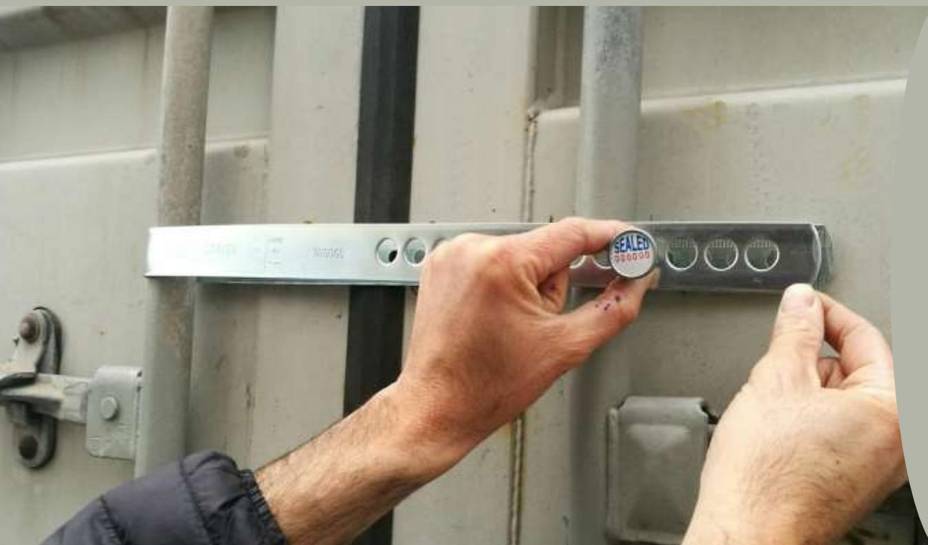
Questo sigillo di sicurezza agisce serrando le due barre centrali del container, bloccando in modo evidente l'apertura delle porte.
