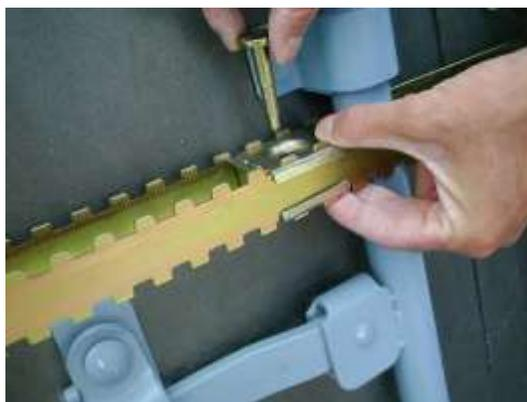
3.) ...Inserire il chiodo di bloccaggio che è HA LE DIMENSIONI per evitare qualsiasi tentativo di manipolazione...
