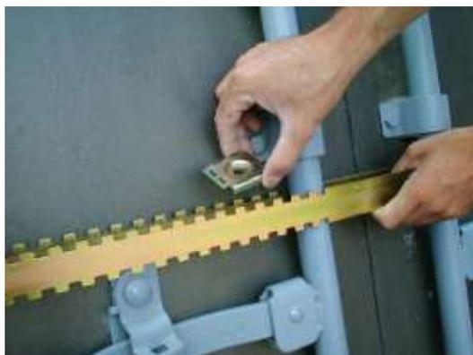
1.) Posizionare il NEW FORKSEAL fra le barre centrali del container ed inserire il primo incastro quanto più vicino alla barra...
