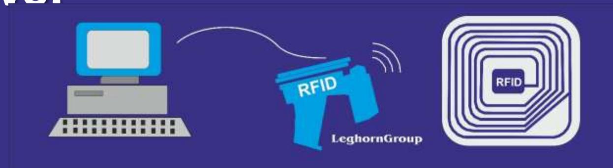
L'identificazione avviene usando un'antenna per leggere, un chip (chiamato tag, o transponder) che è stato applicato sull'oggetto (o persona o veicolo) da identificare.
