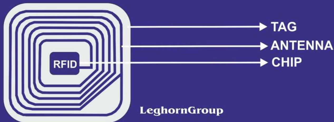
Un'etichetta RFID è una semplice etichetta di identificazione automatica dotata di un microchip e un'antenna.
